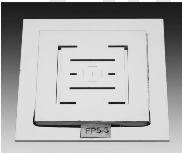
Bild 14 Foto eines kommerziell verfügbaren 1D-Kraft-Einstellnormals für Mikro- und Nanohärtemessgeräte.
